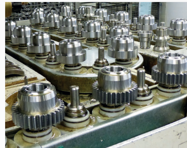
▲ Das automatische Beladesystem mit den Zahnradern auf der Gleason Pfauter Maschine.
